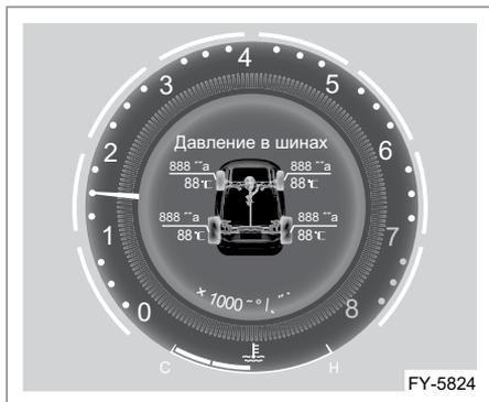
Датчики давления в шинах передают показания давления и температуры в шинах на комбинацию приборов; эти значения отображаются на дисплее комбинации приборов в режиме реального времени. Точность показаний температуры в шине составляет около 1 °С, а показаний давления в шине около — 1 кПа.
