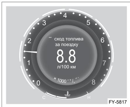
Расход топлива за поездку обозначает расход на 100 км в одном ездовом цикле. Максимальный отображаемый расход топлива за поездку составляет 19,9 л/100 км. После каждого запуска двигателя необходимо проехать на автомобиле определенное расстояние, прежде чем расход топлива за поездку сможет отображаться корректно. После каждого выключения двигателя выполняется автоматический сброс расхода топлива за поездку. После следующего запуска двигателя расход топлива за поездку будет рассчитываться заново.
