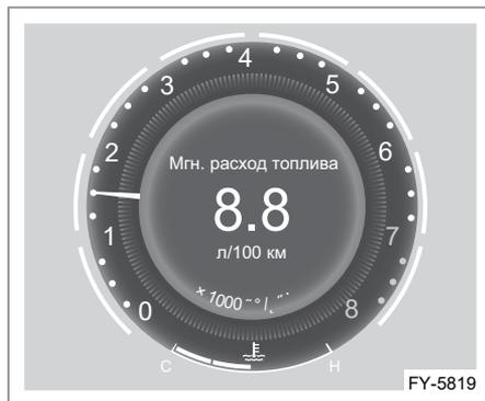
Мгновенный расход топлива отображается в л/100 км. Значение мгновенного расхода топлива не может быть сброшено. На холостом ходу отображается «— л/100 км»;
