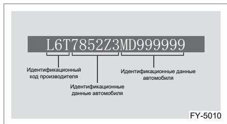
Идентификационный номер автомобиля (VIN) состоит из 17 символов и содержит следующую информацию: код производителя, год выпуска, тип и номер кузова автомобиля, завод-изготовитель автомобиля и т. д.
