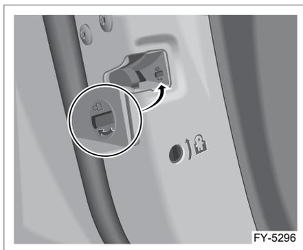
При отключенном питании автомобиля можно использовать механический ключ для запираения двери переднего пассажира и задних дверей. Порядок действий:
