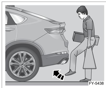
Индуктивная антенна функции открывания двери багажного отделения расположена в центре нижней части заднего бампера.
