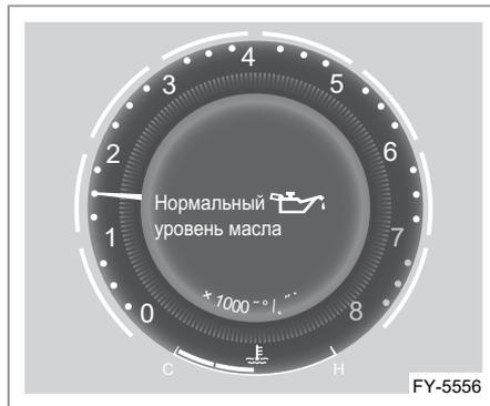
Датчик уровня моторного масла передает показания уровня моторного масла на комбинацию приборов; это значение отображается на дисплее комбинации приборов в режиме реального времени.
